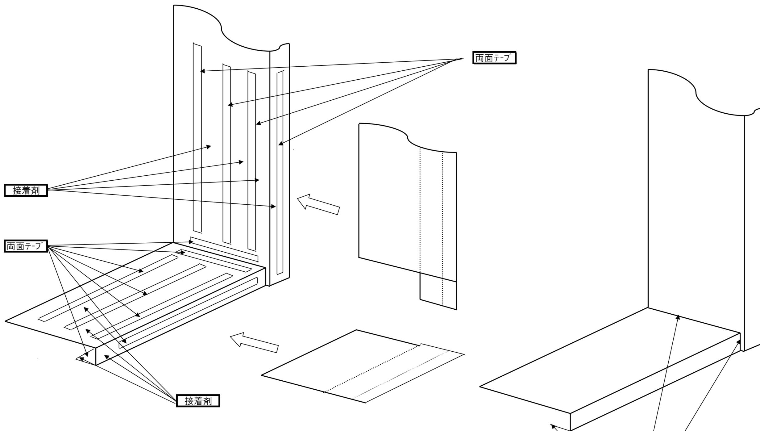
貼る面材を枠の寸法に合わせて加工します。
